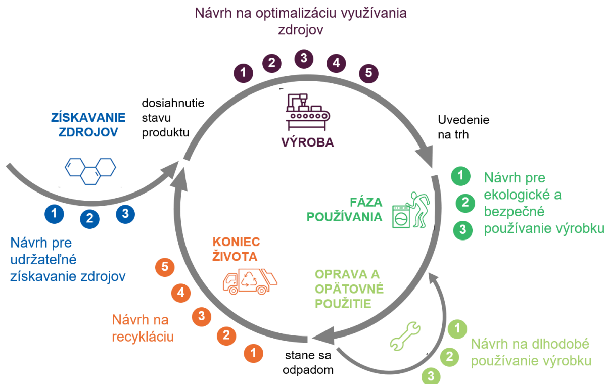
Obrázok 3. Cirkulárny životný cyklus výrobku a plastov. Zdroj: Na základe správy K lepšiemu, nie k horšiemu: Uplatňovanie zásad ekodizajnu na plasty v cirkulárnej ekonomike
